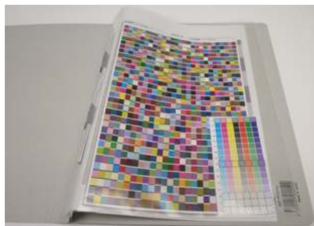
図表 4-2 管理項目表と ISO12642-2 (1617 色) チャート及びステップチャートを綴じた例
