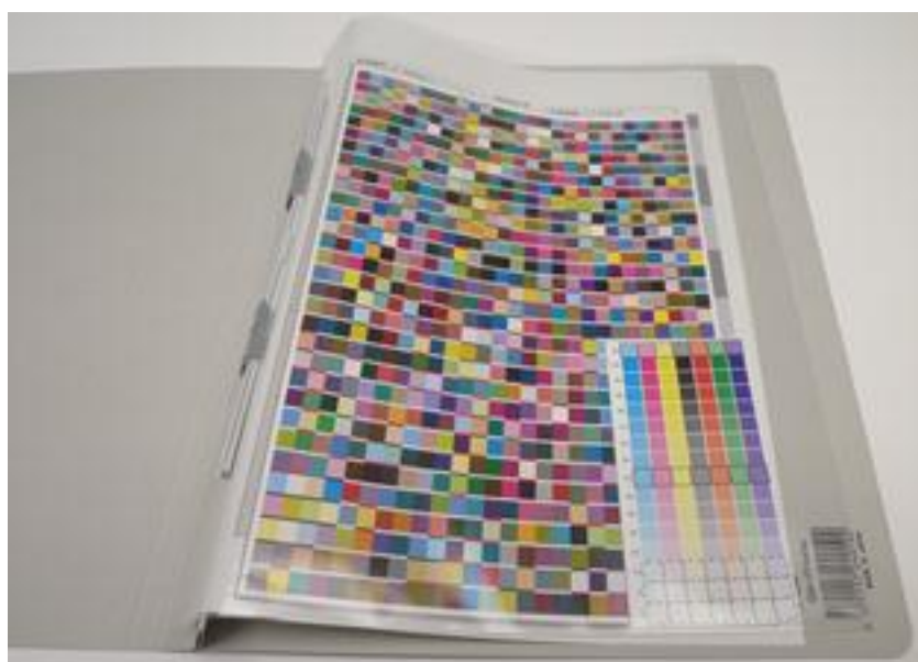
図表 5-5 管理項目表に ISO12642-2（1617色）チャート及びステップチャートを綴じた例
